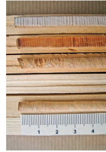
Kappstücke – Hölzer von Bargaruinen, präpariertes Kappstück, Probenmontage und Lupenbild eines auf einem Träger fixierten Bohrkerns 3 (Fichte); Maßbalken \approx 1 mm.
