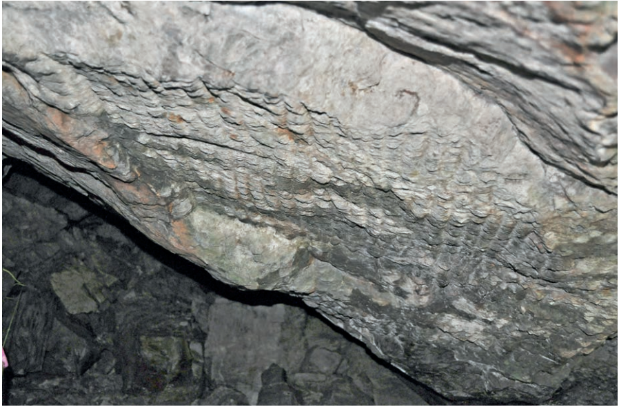
Abb.3 Sideritabbau unter Tage (Befund 3.2) mit deutlichen Schrämmspuren an der Firste (CONTEXT OG, 2009).
